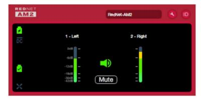
Die obige Abbildung zeigt ein RedNet AM2 mit inaktivem Line Out Mute und zeigt ein auf beiden Kanälen vorhandenes Signal. Es verfügt über PoE-Stromversorgung und eine gesperrte Netzwerkverbindung.
